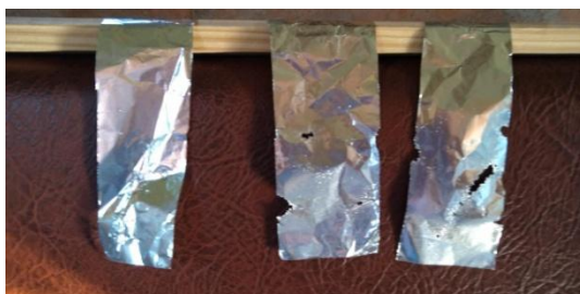
Fig. 3 Foto das tiras de alumínio, após teste no ultrassom
