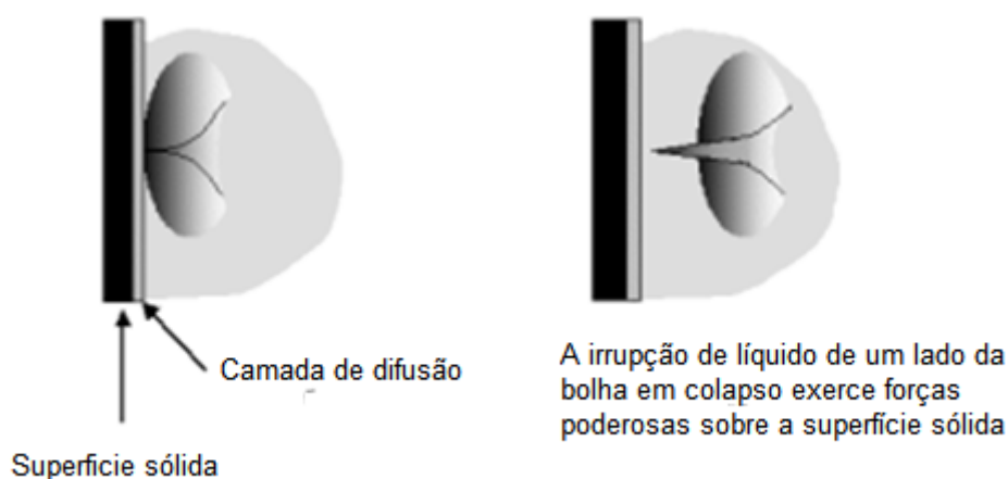
Figura 18 - Colapso da bolha de cavitação em ou próximo a uma superfície sólida Fonte: Adaptado de Mason e Pétrier (2004, p. 5)
