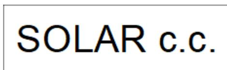
Figura 22 - Ilustração de sinalização para caixas de junção
