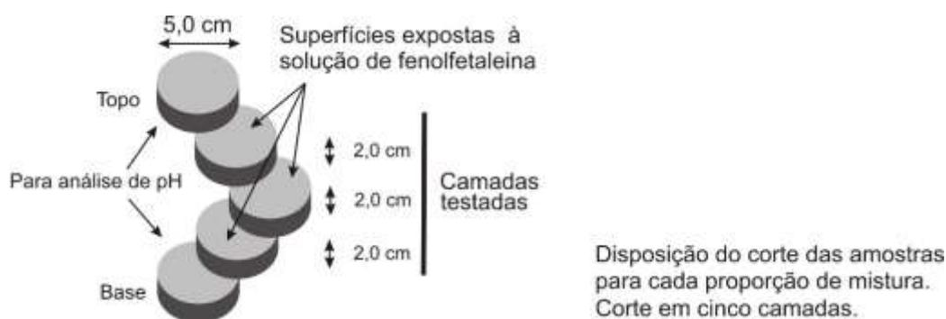
**Figura 23:** Sentido de corte dos corpos de prova em cinco camadas
