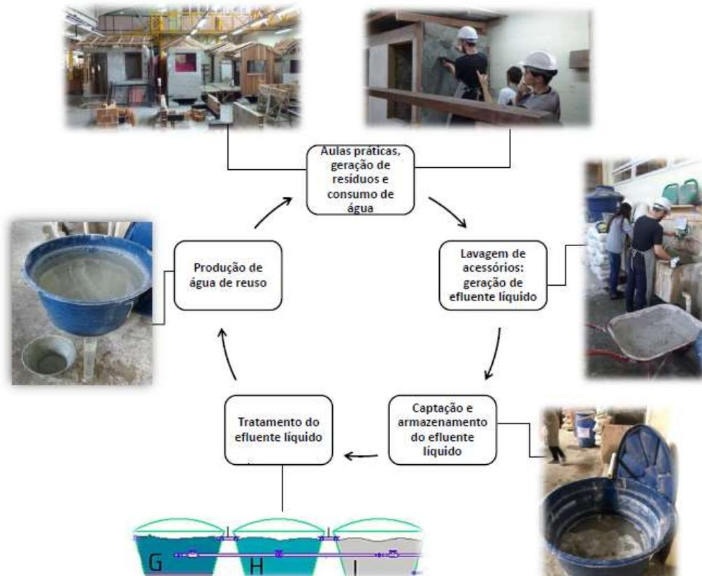
**Figura 29:** Ciclo de geração do efluente líquido e água de reuso
