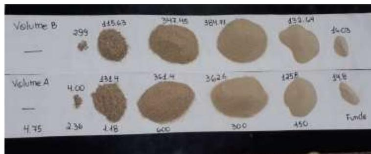
**Figura 8:** Agregado miúdo, Composição granulométrica da areia utilizada no experimento.
