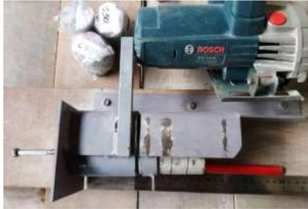
**Figura 24:** Equipamento desenvolvido para cortar corpos de prova
