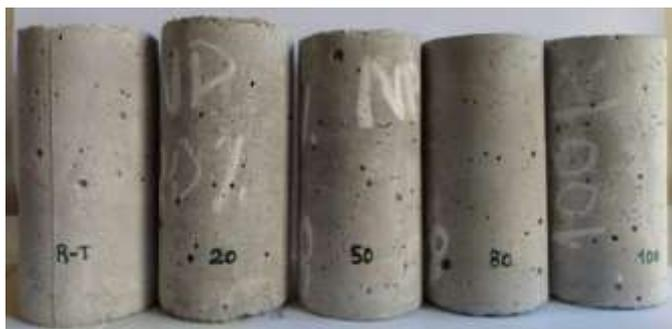
**Figura 19:** Corpos de prova (5x10 cm), para estudo de carbonatação natural
