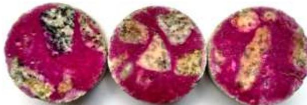
**Figura 26:** Exemplo de amostras de concreto expostas à fenolfetaleína após carbonatação
