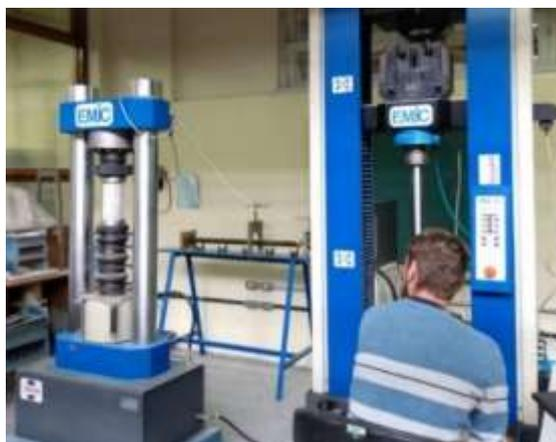
**Figura 22:** Ensaio de compressão axial dos concretos produzidos
