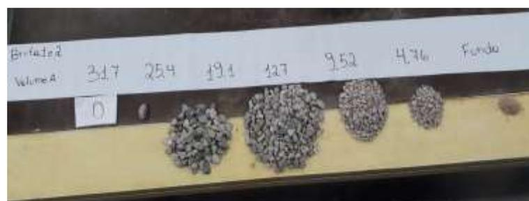
**Figura 9:** Agregado graúdo, Composição granulométrica da brita 1 e brita 2 (experimento)
