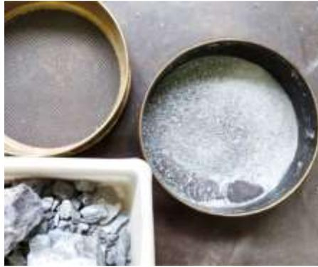
**Figura 20:** Preparo das amostras de concreto endurecido para análise de pH
