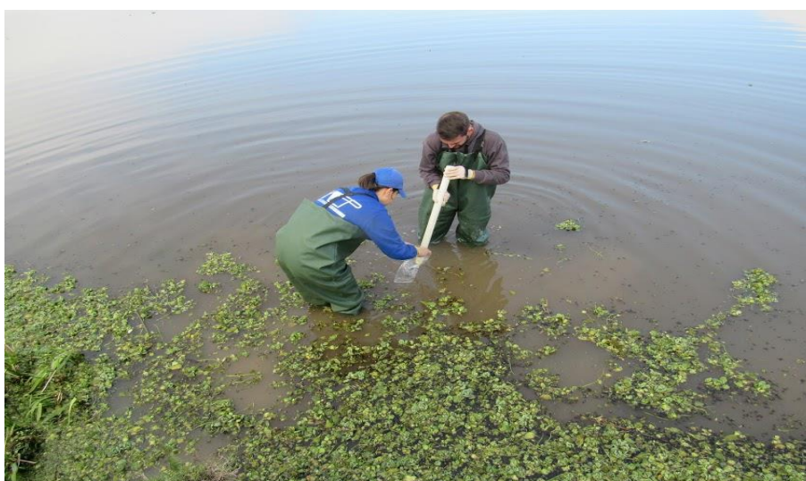
Figura 12. Demonstração da utilização do amostrador do tipo “Core”.
