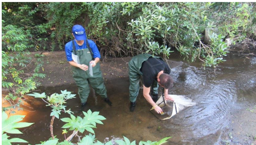
Figura 14. Demonstração da utilização do amostrador do tipo “Surber”.
