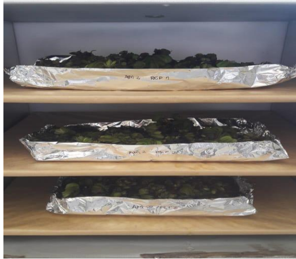
Figura 18. Amostras de macrófitas aquáticas no processo de secagem em estufa elétrica a 60 °C.
