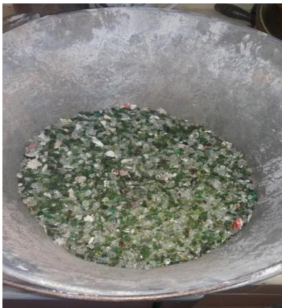
Figura 23 - Sucata de vidro moída da COOTAFRA. Fonte: acervo do autor
