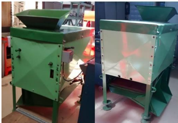
Figura 12 - Moedor de caliças e resíduos cerâmicos MC-96, com sistema de mandíbulas e peneiras, marca SCHREINER. Fonte: acervo do autor
