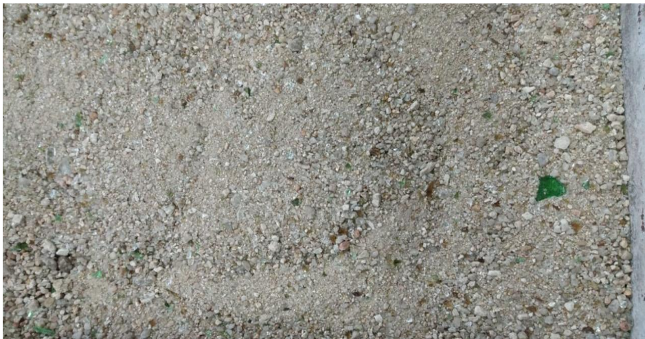
Figura 18 - Resultado da mistura da areia com 20% de resíduo de vidro moído. Fonte: acervo do autor
