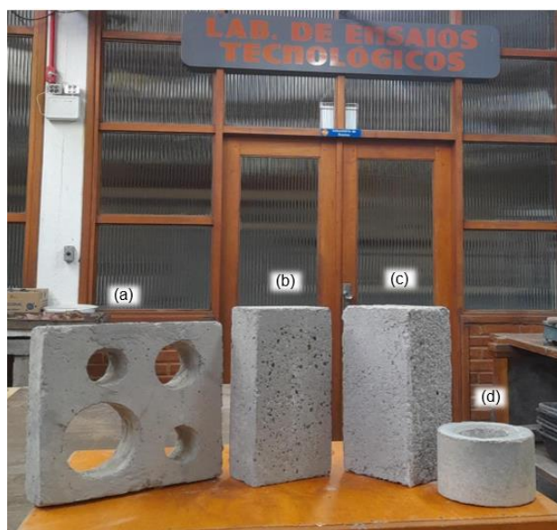
Figura 45 - Artefatos com resíduo de vidro moído. Fonte: acervo do autor (a) Cobogó; (b) Tijolo; (c) Paver; (d) Vaso para plantas
