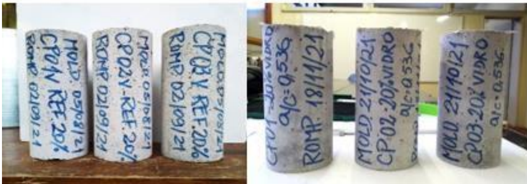
Figura 38 - Corpos de prova identificados para o ensaio de compressão. Fonte: acervo do autor
