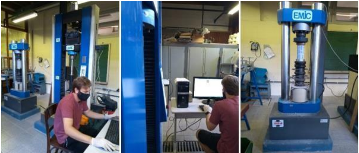
Figura 40 - Ensaio de compressão axial dos corpos de prova produzidos. Fonte: acervo do autor
