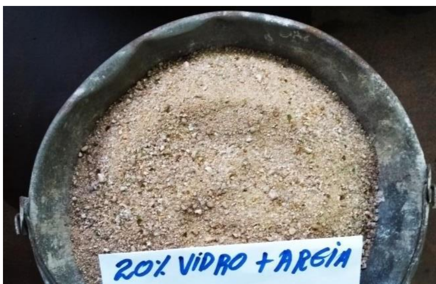
Figura 24 - Composição da areia com 20% de resíduo de vidro moído. Fonte: acervo do autor
