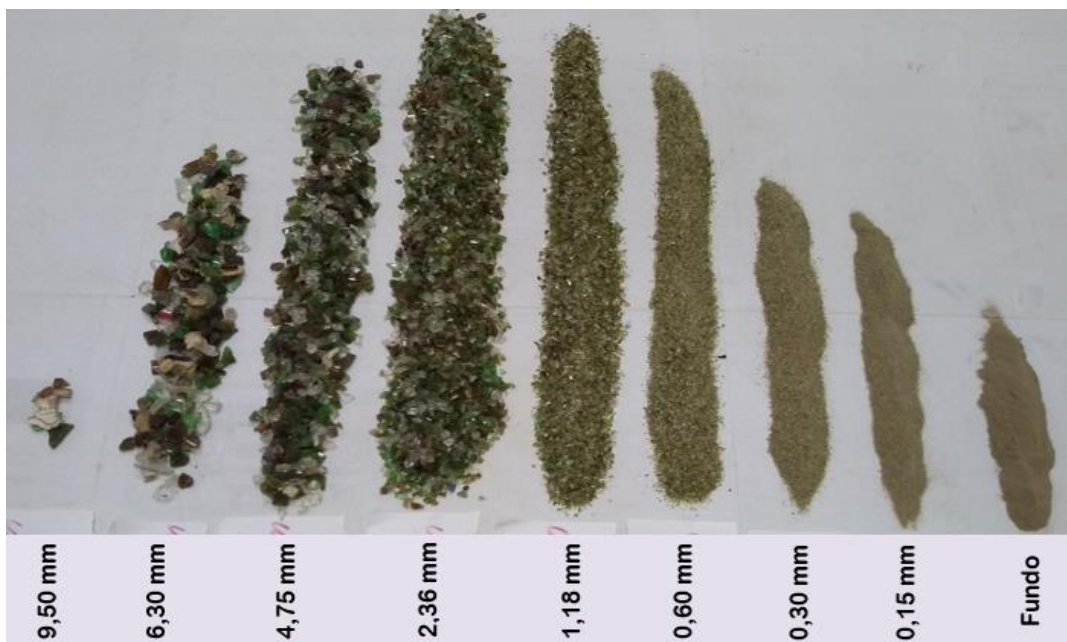
Figura 15 - Composição granulométrica do resíduo de vidro moído. Fonte: acervo do autor
