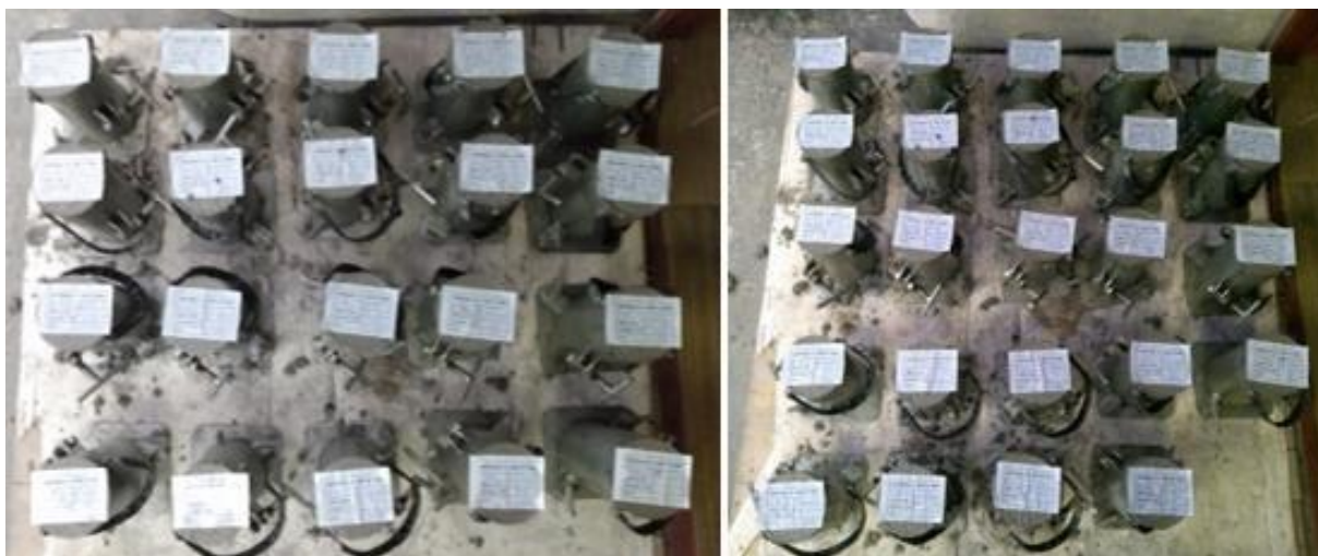
Figura 35 - Corpos de prova moldados no laboratório do curso de Edificações. Fonte: acervo do autor
