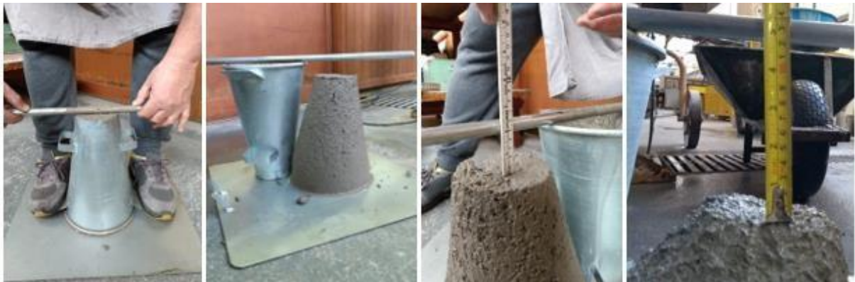
Figura 32 - Medições do abatimento do tronco de cone – Slump Test. Fonte: acervo do autor
