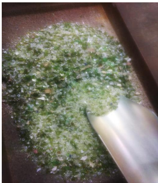
Figura 13 - Resíduo de vidro moído fornecido pela COOTAFRA. Fonte: acervo do autor
