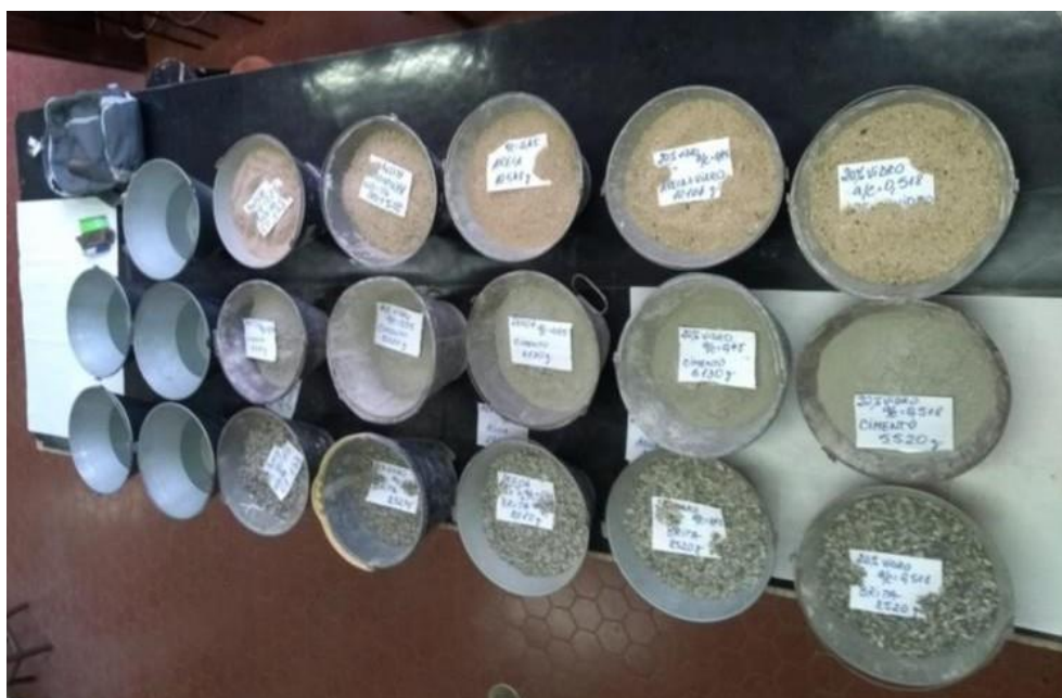
Figura 29 - Porcionamento dos materiais para produção das dosagens. Fonte: acervo do autor
